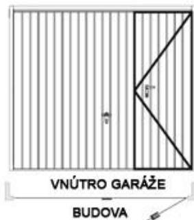
Obr. 10 Štandardné prechodové dvere pravé – pohľad zvonku
