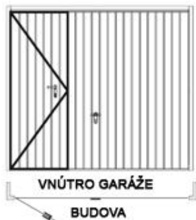
Obr.9. Štandardné prechodové dvere ľavé – pohľad zvonku
