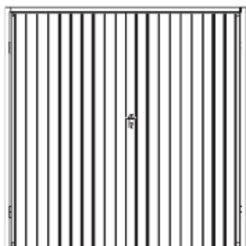
Obr. 1 Dvojkřídlová oceľová brána
