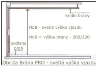
Obr.2a Brána PRO - světlná výška vjazdu
